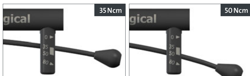
Affichage du couple de serrage sur le dispositif dynamométrique.
