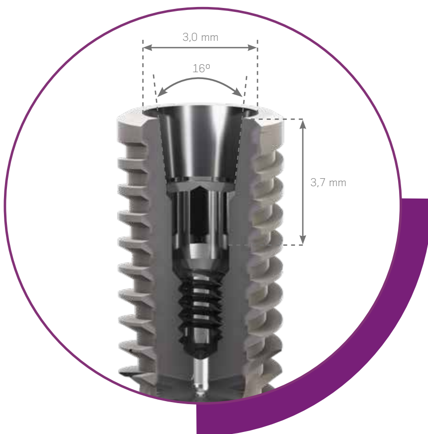
FIGURA 3. O implante Grand Morse® Neodent® tem uma profunda conexão em seu interior, desenhada para aumentar a área de contato entre implante e intermediário protético.
