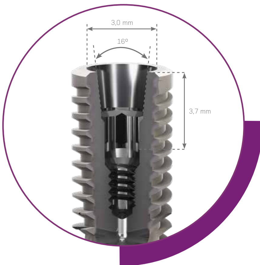
FIGURA 3. El implante Grand Morse Neodent tiene una profunda conexión en su interior, diseñada para aumentar el área de contacto entre implante y componente protésico.
